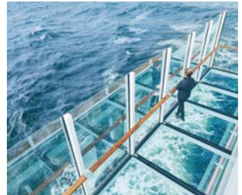
Ausfahrbare, gläserne Balkone
